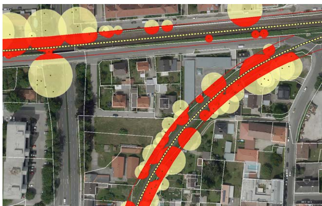
Abb. 8: Verschneidung zwischen verschiedenen Objektklassen führt zu einer Erkennung einer möglichen Gefahrenlage.
