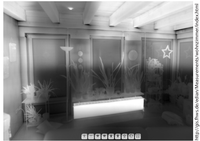
Abb. 4: Thermografiepanorama eines Wohnzimmers; Kältebrücken an der Decke und den Türen erscheinen dunkel, Wärmequellen, wie z. B. der Heizkörper, hingegen hell.
