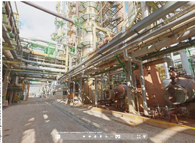
Abb. 3: Digitalisierte Industrieanlage zur Inventur. Da der piXplorer 500 sieben HDR-Stufen aufnimmt und ab ~1 m fokussiert abbildet, sind keine Anpassungen nötig.
