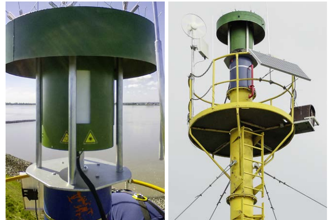
Abb. 4: Nahaufnahme des Schutzgehäuses mit geschlossenem Sichtfenster und Wetterdach (links). Vollständiger Systemaufbau auf Messplattform mit Schutzgehäuse, Solarzelle und Windgenerator (rechts)
