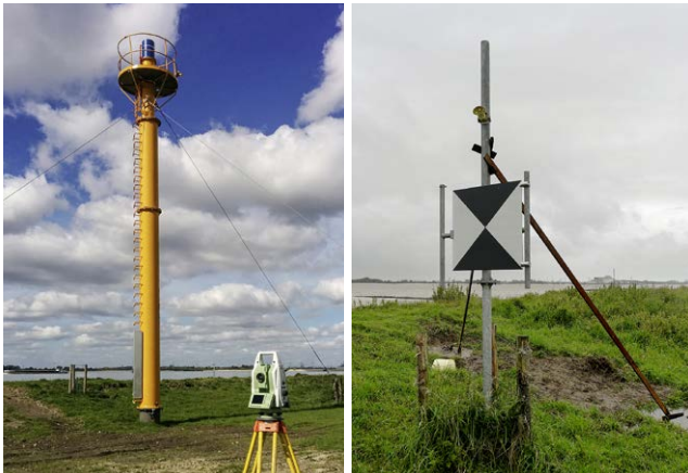
Abb. 3: Messplattform am Fuß des Sommerdeichs (links), verstrebt Pfeiler mit Schwarz-Weiß-Zielzeichen 80 × 80 cm (rechts)
