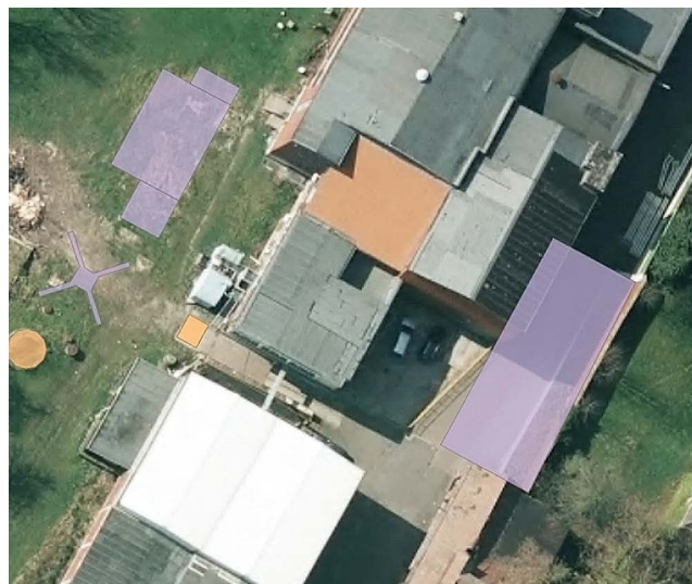
Abb. 3: Überlagerung eines DOP mit einem Datensatz der Gebäude mit einer Höhe unter einem Meter (violett). Die in ALKIS nachgewiesenen Gebäude sind im Luftbild nicht zu erkennen.
