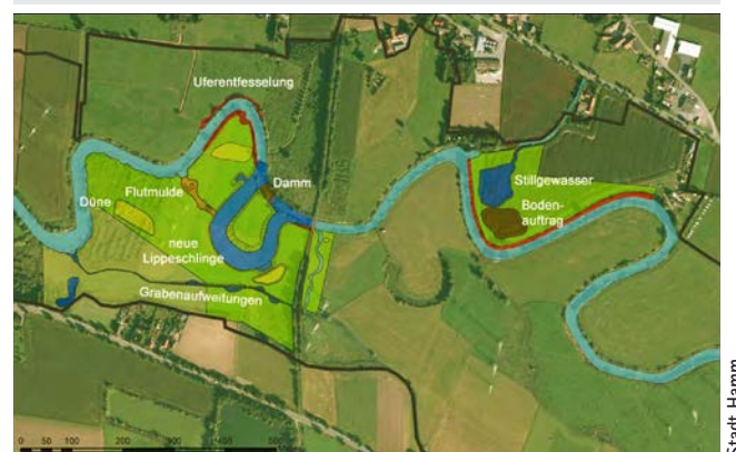
Die größte Maßnahme in Block D südöstlich von Ahlen-Dolberg ist der Bau einer neuen Lippeschlinge nahe der ehemaligen Zechenbahn, der heutigen Radwegeverbindung Dolberg-Haaren.
