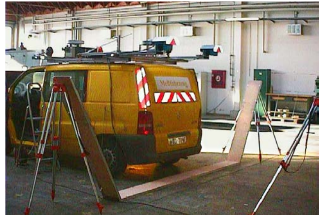
Abb. 1: Beispielhafter Messaufbau bei der Kalibrierung von Profillaserscannern
