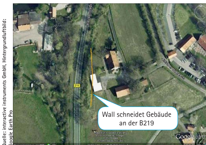
Abb. 5: Beispiel eines Lagekonfliktes von Lärmschutzeinrichtung (gelb) und Gebäude als Prüfziel der Nachveredelungs-Prüfungen
