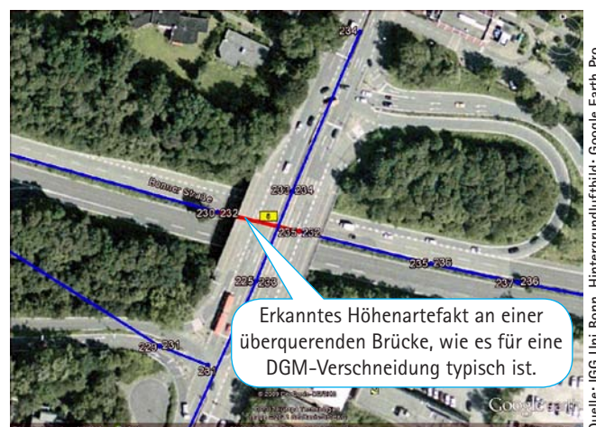
Abb. 6: Beispiel für einen Fehler, der durch das Ausreißertool aufgedeckt wurde: Im Bereich der Überführung einer Autobahn durch eine Brücke tauchen extrem starke Steigungen auf, die im Kontext der Autobahn ungewöhnlich sind.
