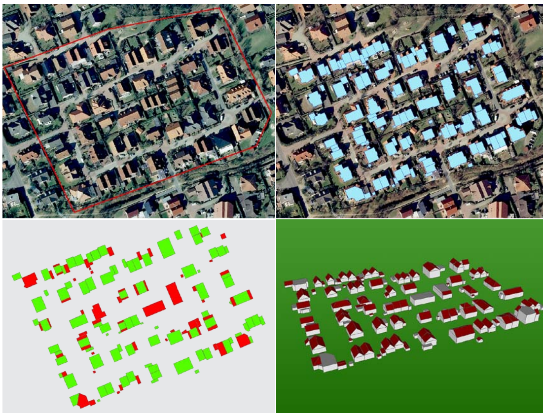
Abb. 10: Test LoD2-Prozessierung mit dem Softwarepaket tridicon (GTA 2012): Oben links: Testgebiet im DOP. Oben rechts: Überlagerung der ALKIS®-Grundrisse. Unten links: Erkennungsrate der Prozessierung (grün: Dachform korrekt modelliert, rot: nicht korrekt modelliert). Unten rechts: Vollautomatisch generiertes DGB-LoD2
