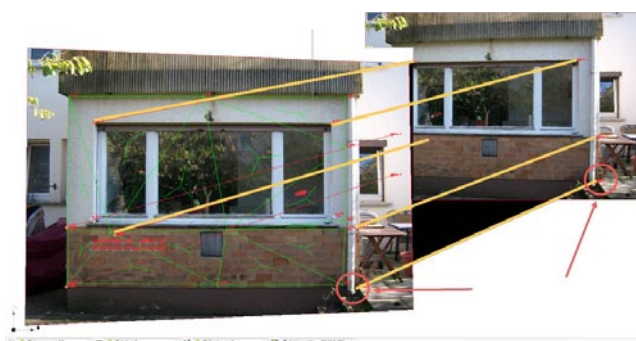
Abb. 4: Projektivtransformation, entzerrte Kameraaufnahme (Bruschi 2009)
