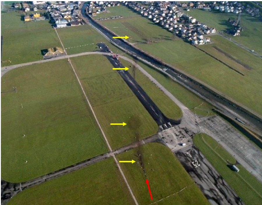
Abb. 16: Luftaufnahme der Unfallstelle mit den Aufprallspuren. Der rote Pfeil zeigt die Flugrichtung des abgestürzten Flugzeuges, die gelben Pfeile die Absturzspuren am Boden.
