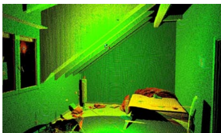
Abb. 12: 3D-Punktewolke des Tatortzimmers, erstellt mit der Scanstation 2
