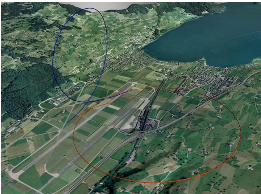
Abb. 20: Rekonstruktion der beiden Flugwege. Diese Flugbahnen wurden in Echtzeit animiert. Es wurden Videos aus der Vogelperspektive und aus Sicht der Piloten erstellt. Damit konnte gezeigt werden, zu welcher Zeit sich die beiden Flugzeuge gesehen haben müssten.
