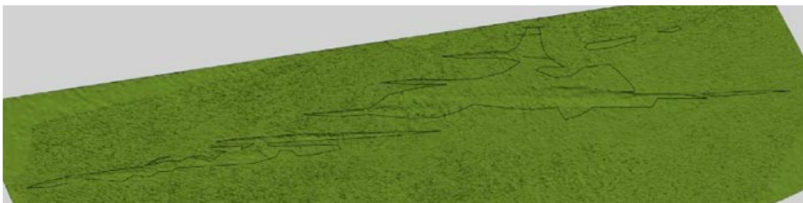
Abb. 17: 3D-Modell der mittels Laserscanning erfassten Aufprallspur des Flugzeuges
