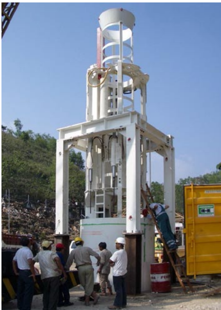
Abb. 6: Vertikalbohr- maschine der Firma Herren- knecht AG
