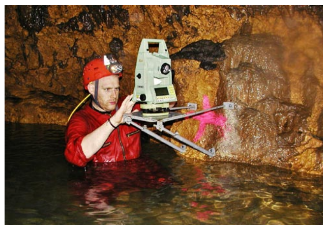
Abb. 4: Messkonsole im Seebereich Bribin
