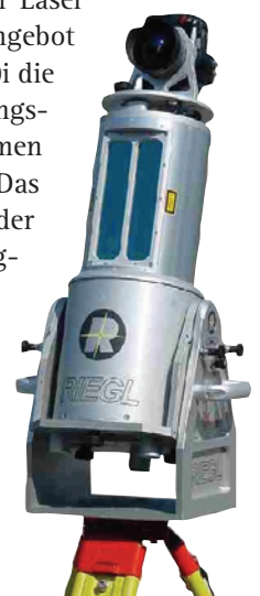
Abb. 5: Der Laserscanner Rieggl LMS-Z360i (Rieggl)
