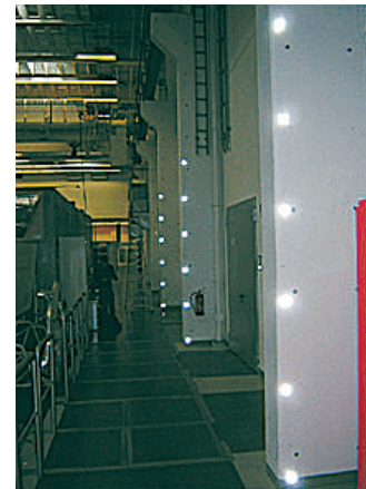
Abb. 4: Anordnung der Reflexmarken zur Kamera-kalibrierung
