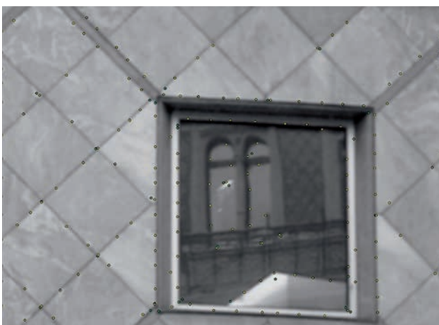
Abb. 6: (a) Bildpunkte erfasst mit dem Förstner und dem Harris Operator; (b) Erfasste Bildpunkte nach Anwendung der entwickelten Punktfilterung
