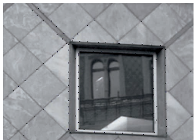
Abb. 6: (a) Bildpunkte erfasst mit dem Förstner und dem Harris Operator; (b) Erfasste Bildpunkte nach Anwendung der entwickelten Punktfilterung
