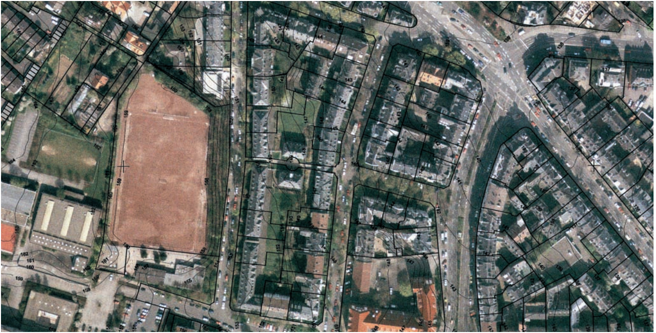
Abb. 2: Digitale Stadtgrundkarte Wiesbaden, Komponenten ALK (nur Flurstücksgrenzen), Orthophoto und Höhenlinien (Maßstab ca. 1 : 3000)
