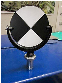
Abb. 3: Zieltafel mit Zylinderadapter für Taylor-Hobson-Kugel
