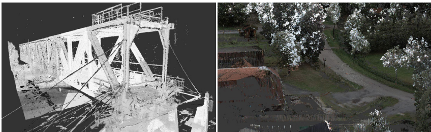
Abb. 13: TLS-Punktwolke von Friesenbrücke (links) und TIMMS-Punktwolke der Zufahrten (rechts)
