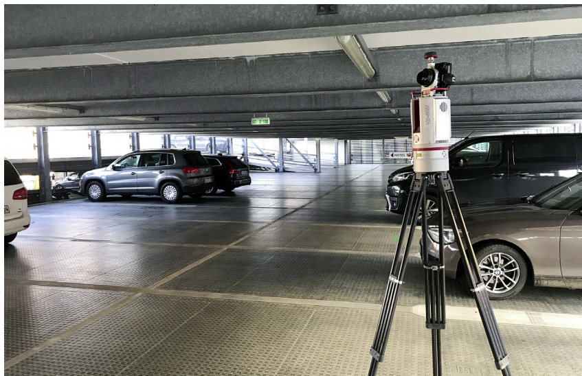
Abb. 1: RIEGL VZ-400i Laserscanner bei der Datenaufnahme im Parkhaus
