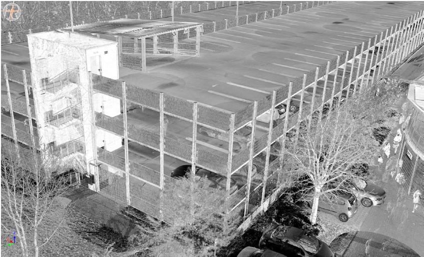
Abb. 2: Dreidimensionale Ansicht der registrierten Punktwolke
