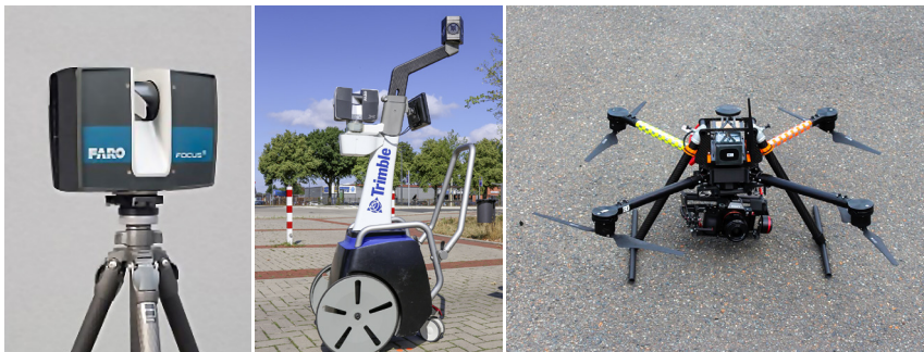
Abb. 3: Faro (links), TIMMS (Mitte) und UAV (rechts)
