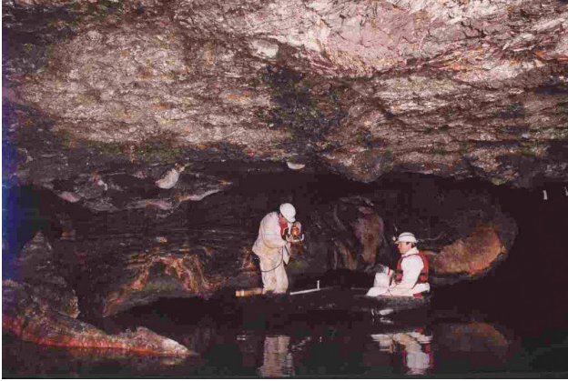
Abb. 3: Vermessung mit Markscheider- Hängezeug
