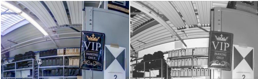
Abb. 6: Beispielscan, links in RGB-Farben, rechts Intensitätsdarstellung
