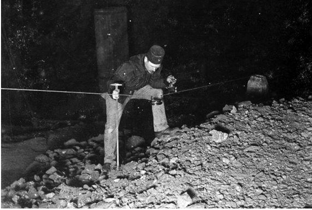
Abb. 1: Vermessung mit Markscheider- Hängezeug im Ablasswerk
