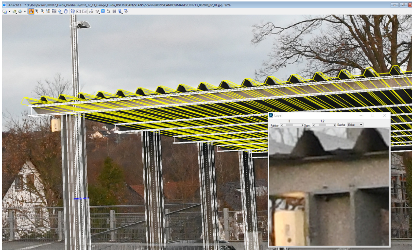
Abb. 4: Bildauswertung von Details in PHIDIAS
