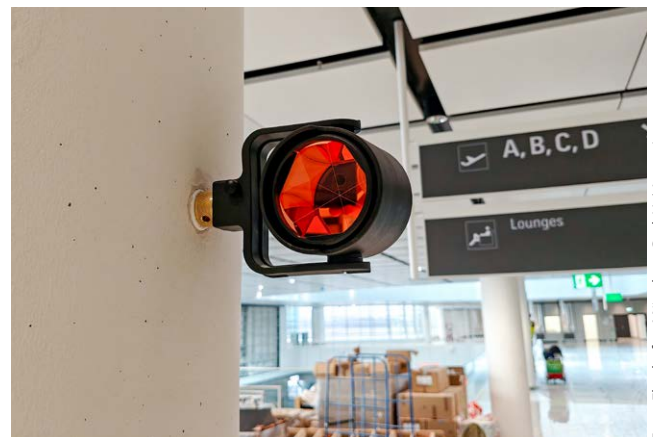
Abb. 3: Wandbolzen mit aufgeschraubtem Prisma
