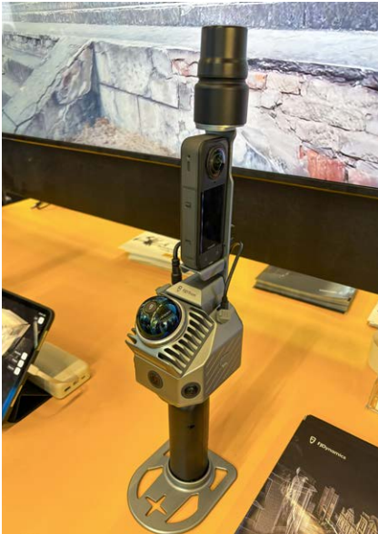
Abb. 2: Sensor-Fusion bei einem handgehaltenen, SLAM-fähigen Mobile-Mapping-System: FJD Trion
