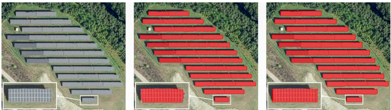
Abb. 7: Segmentierungsergebnis einer Freiflächen-Photovoltaikanlage (DOP20 links, U-Net Ergebnis Mitte, YOLO Ergebnis rechts)
