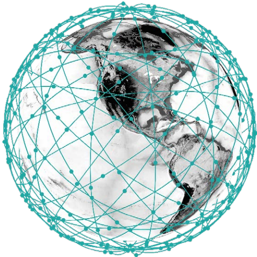
Abb. 1: Animation einer LEO-PNT Konstellation mit 300 Satelliten (XONA Space Systems, Reid 2022) im 1000-km-Orbit
