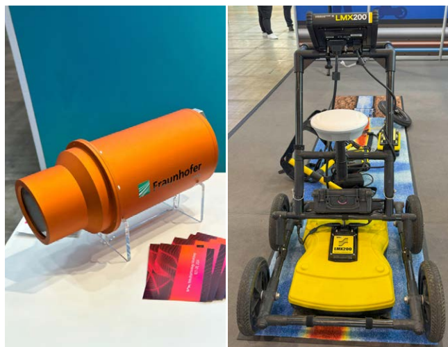
Unterwasser-LiDAR-Scanner (links), Ground-Penetrating-Radar-gerät (rechts)
