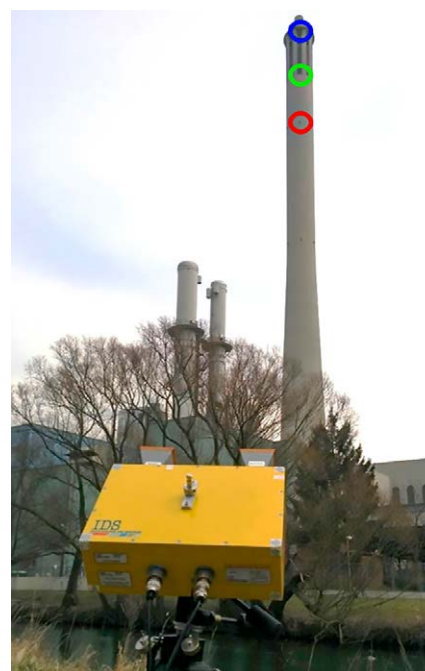
Abb. 9: Messung windinduzierter Schwingungen eines 180 m hohen Schornsteins mit drei exemplarisch ausgewählten Rückstreuern, farbige Ringe (s. a. Abb. 12)
