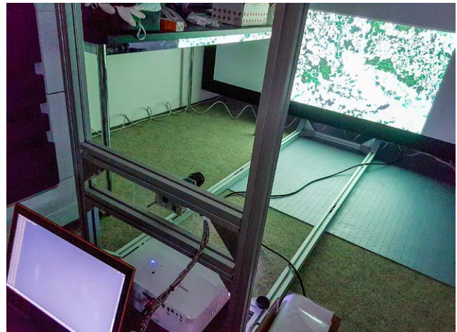
Abb. 8: Test der erzielbaren Aufnahmequalität mit der eingesetzten Kamera mit am Bildschirm eingeblendeten Überflugdaten, in die unterschiedliche Störungs-niveaus eingeblendet werden können.
