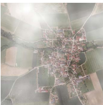
↑ Abb. 6: Simulationsdaten: Links: Ausgangsbild (TrueDOP, 40 cm). Mitte: Aufnahme und Downsampling (perspektivisches Zeilenbild, 4 m). Rechts: simuliertes Satellitenbild (gefiltertes und modifiziertes perspektivisches Zeilenbild, 4 m)
