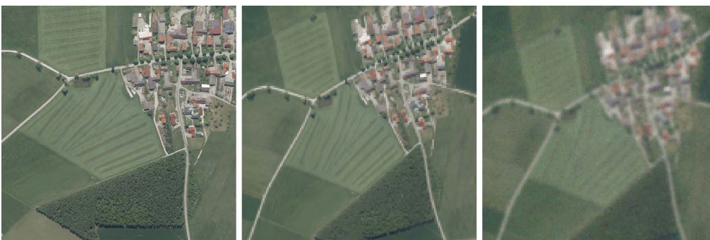
↑ Abb. 6: Simulationsdaten: Links: Ausgangsbild (TrueDOP, 40 cm). Mitte: Aufnahme und Downsampling (perspektivisches Zeilenbild, 4 m). Rechts: simuliertes Satellitenbild (gefiltertes und modifiziertes perspektivisches Zeilenbild, 4 m)
