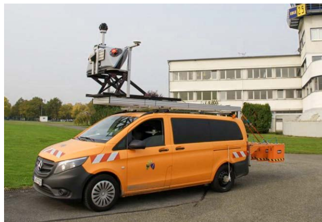
Abb. 2: Mobiles Multi-Sensor-Messfahrzeug der Stadt Essen
