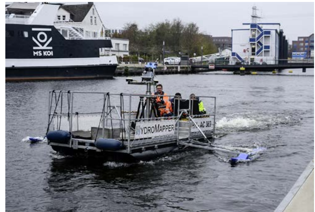
Abb. 2: Testfahrt mit der HydroMapper-Plattform mit Dual-GNSS und Profilschanner
