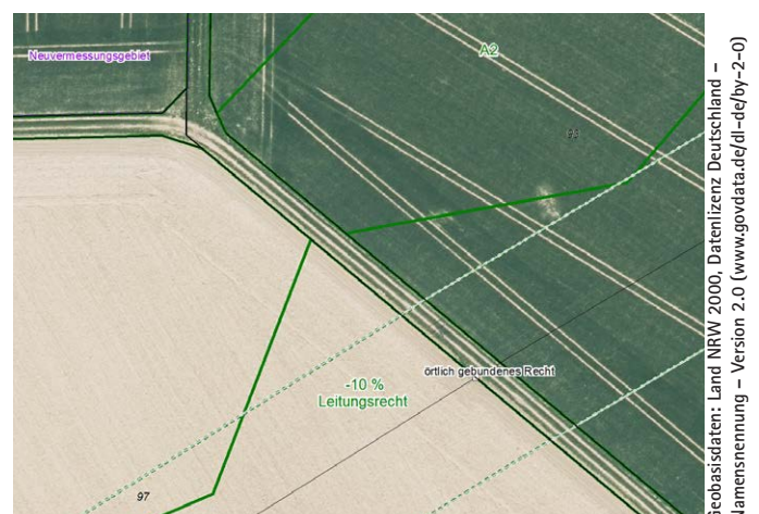
Abb. 1: Berücksichtigung eines Leitungsrechtes in der Bodenordnung
