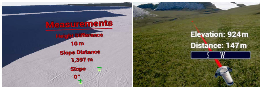
Abb. 9: Höhendifferenz- und Neigungs- messungen zwischen zwei Punkten in VR (links) und Höhen- und Distanzmessungen in VR (rechts)
