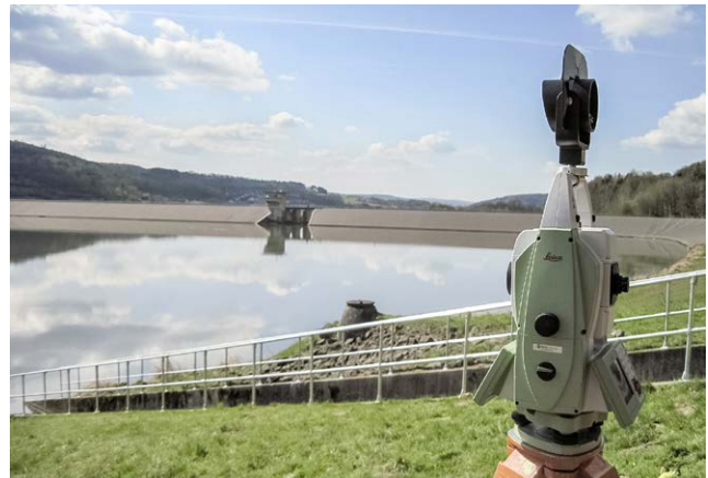
Abb. 1: Wasserseitiger Blick auf den geschütteten Staudamm der Kinzigtalsperre während der trigonometrischen Höhenübertragung mittels gleichzeitig gegenseitiger Zenitdistanzmessung (GGZ)
