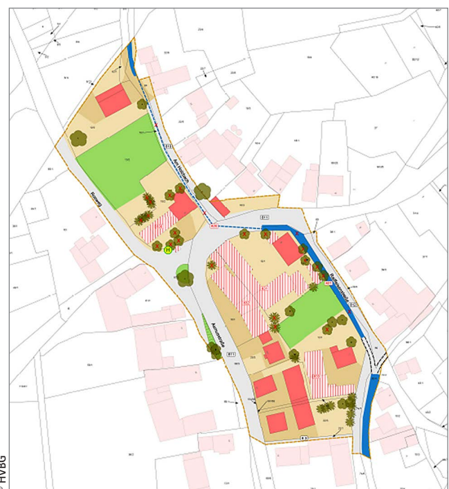
Abb. 9: Bebra-Asmushausen vor der Umgestaltung: Die schraffierten Gebäude werden später abgerissen; der Bach verläuft teilweise verrohrt in der Straße.
