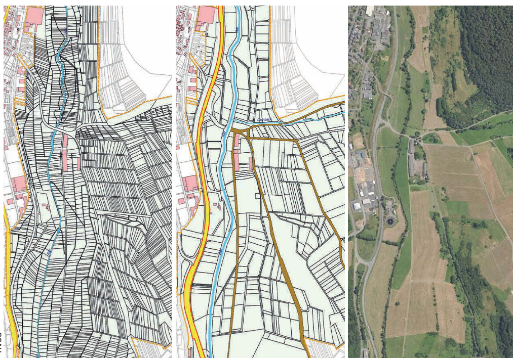
Abb. 6: Grundstücksstruktur und Wegenetz vor (links) und nach der Bodenordnung (Mitte) sowie Umgehungsstraße nach der Verkehrsfrei-gabe (rechts)
