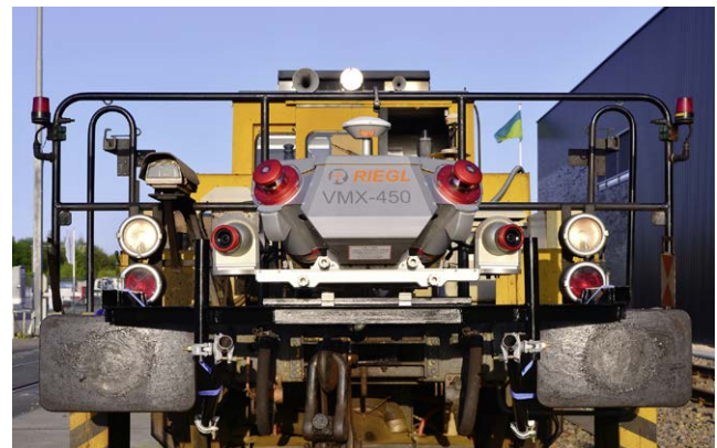
Abb. 1: Riegl VMX-450 Mobile Mapping System auf dem Messzug. Deutlich sichtbar sind die GNSS-Antenne und die zwei Scanköpfe.
