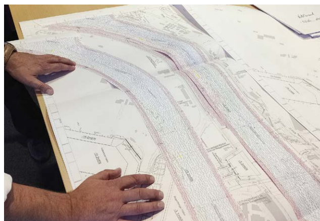
Abb. 1: Peilplan mit Tiefenzahlen und -linien
