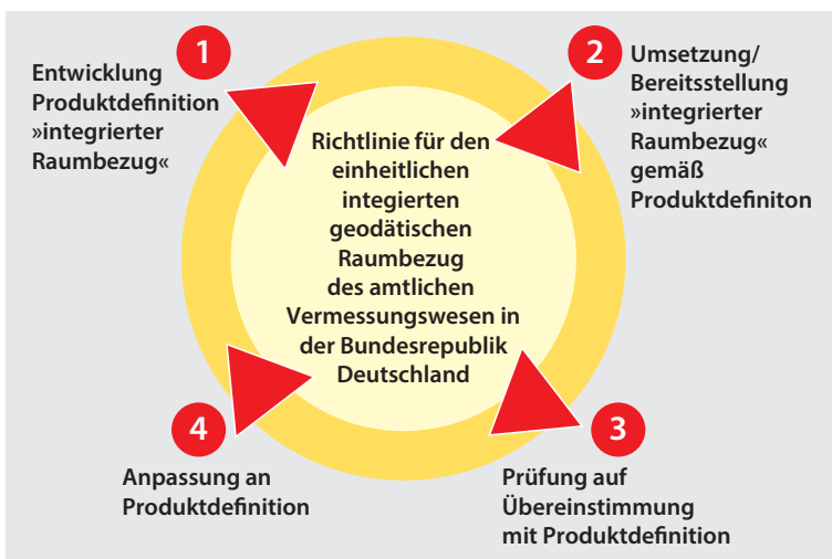
Abb. 1: Regelkreis Qualitätssicherung zum Produkt »Geodätischer Raumbezug«
