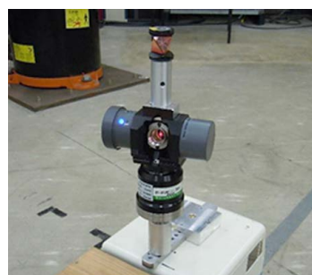
Abb. 10: Kombination aus Tachymeterprisma (oben) und Active Target (unten) am Modell-LKW
