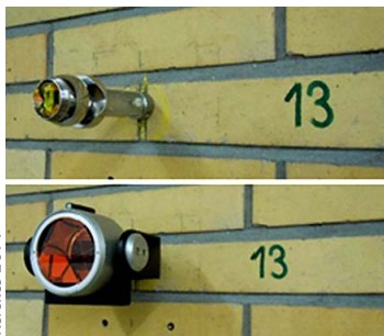
Abb. 12: Signalisierung der Referenzpunkte des Messkellernetzes am IIGS. Oben: sphärischer Reflektor mit Adapter für Laser-Tracker-Betrieb, unten: Leica Rundprisma GPH1P für Tachymeterbetrieb
