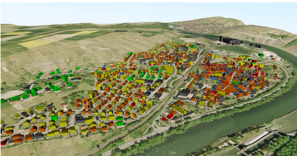
Abb. 3: Wärmebedarfsberechnung auf Basis eines 3D-Stadtmodells für das Klimaschutzkonzept Landkreis Ludwigsburg, hier Gemeinde Aldingen (Modellrechnung). Datenquelle: Landesamt für Geoinformation und Landentwicklung Baden-Württemberg (3D-Gebäudemodell LoD2, Stufe 2) und Nexiga GmbH (Baualtersklasse)
