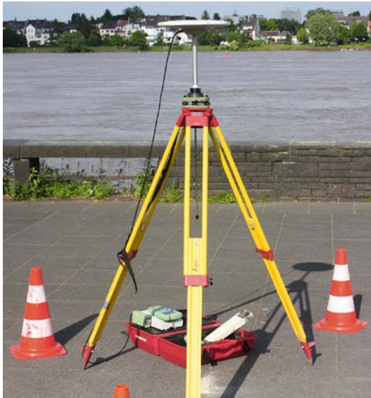
Abb. 4: Aufbau einer der GNSS-Stationen. Als Antennen wurden Trimble Geodetic 2 Antennen verwendet. Die Messaufbauten der Stationen der einzelnen Basislinien wurden möglichst gleich gehalten (z. B. Ausrichtung des Stativs nach Norden, Fixierung des Antennenkabels am Nordbein, etc.), um systematische Abweichungen zu reduzieren.
