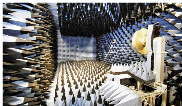
Abb. 4: Antennenkalibrierung in der Antennenmesskammer Bonn
