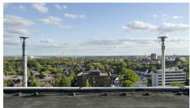
Abb. 3: Referenzstation Düsseldorf – Antennenstandorte: links: G1 (GPS); rechts: G2 (GPS/GLONASS)
