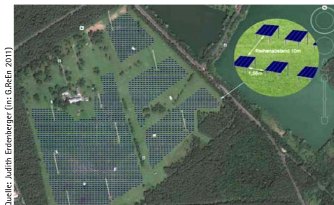
Abb. 7: Darstellung einer Bestückung mit Solarmodulen der Größe 1 m × 1,56 m, Abstand zwischen den Modulen = 1,56 m, Reihenabstand = 10 m
