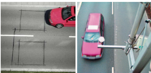
Abb. 2a und b: Induktionsschleife zur Verkehrszählung (linkes Bild) und über Kopf angeordneter TEU-Sensor (rechtes Bild). Quelle: www.siemens.com
