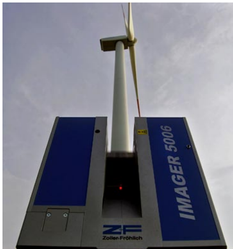
Abb. 4: Scanner während der Aufnahme des Pylons einer Windenergieanlage (2D-Modus)
