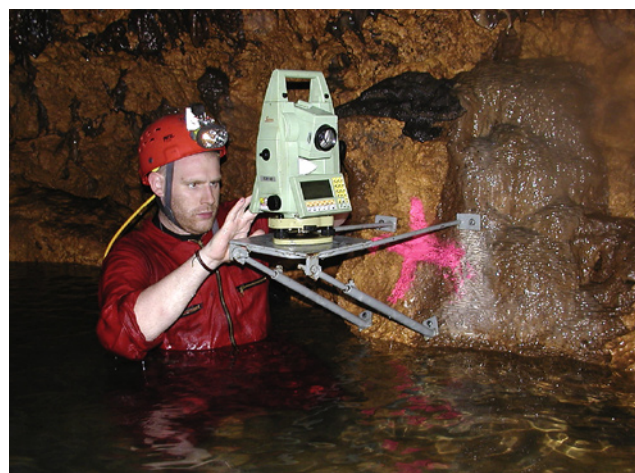
Abb. 4: Konsolenmessung im Seebereich
