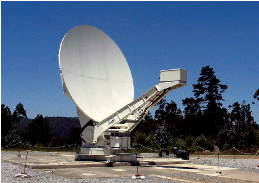
Abb. 3: Das 6 m-Radioteleskop des Transportablen Integrierten Geodätischen Observatoriums (TIGO)
