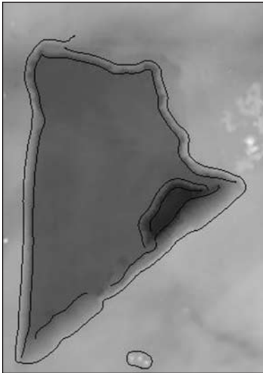
Abb. 10 (a): Kantendetektion mit Laserscannerdaten (Originaldaten: 200 x 280 Pixel, DHM-Maschenweite: 4 m)
