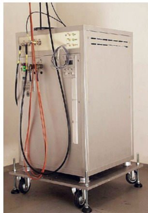
Abb. 13: Wasserstoffmaser, ein hochgenauer Frequenz-generator
